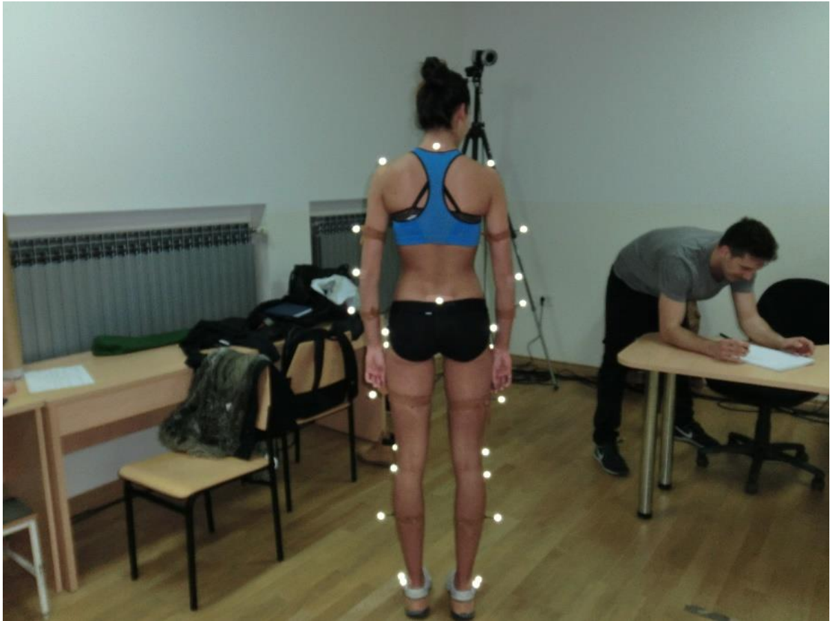
Slika 9. Način na koji su postavljene reflektirajuće markacije, i mjesto na kojem je postavljena točka sakruma. (točka u sredini kičmenog stupa nešto iznad sredine zdjelice)
