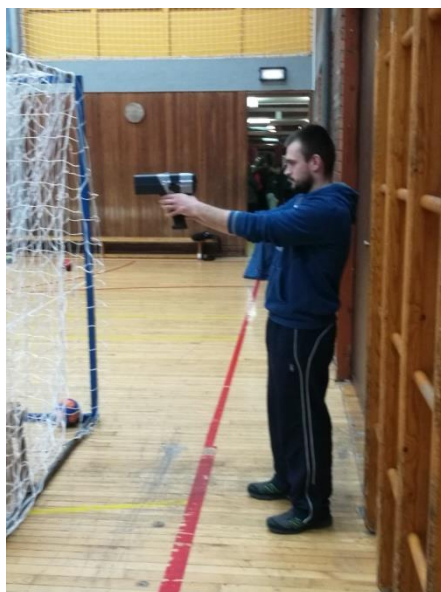
Slika 7. Mjerenje brzine kretanja lopte radar pištoljem (Stalker ATS)
