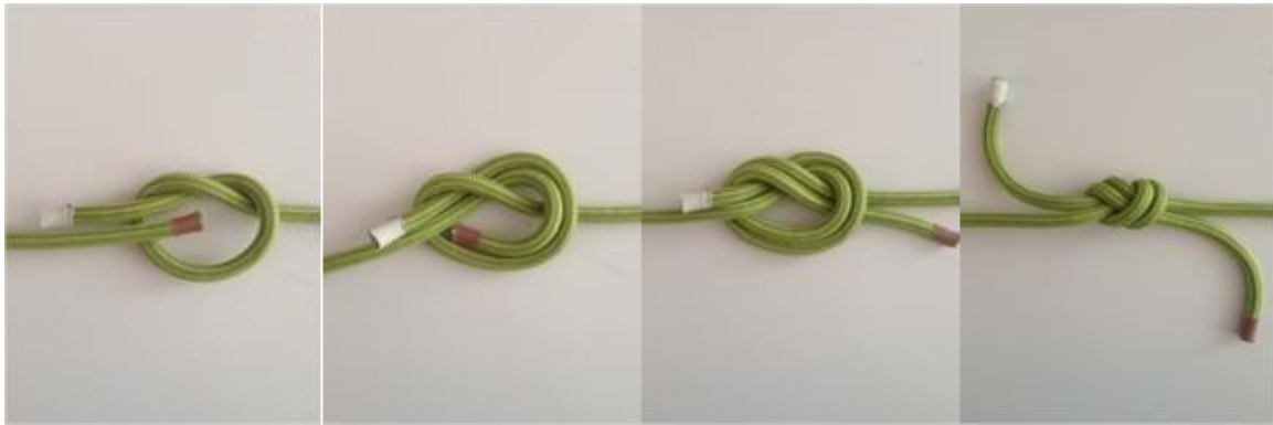
Slika 13. Obični spojni uzao
