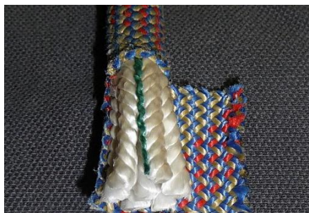
Slika 4. Rascjep sintetičke užadi
