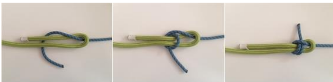
Slika 22. Dvostruki zastavni uzao
