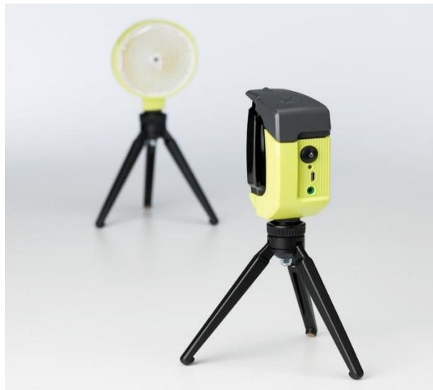
Slika 2. Witty GATE fotoćelije (slika preuzeta sa https://training.microgate.it/en/products/witty/wittygate )
