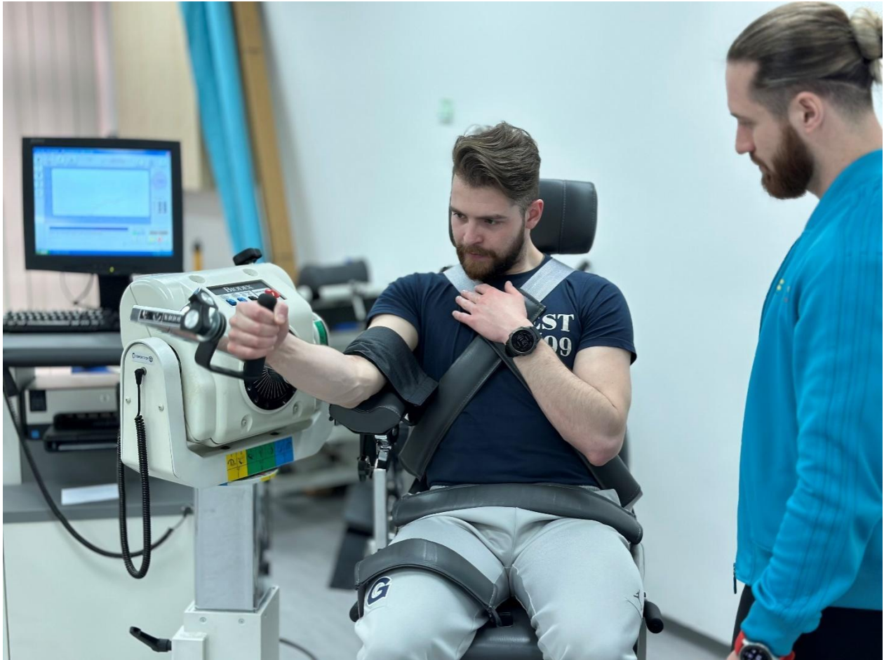
Slika 13. Mjerenje maksimalne koncentrične jakosti mišića ispružaća i pregibača lakta izokinetičkim dinamometrom
