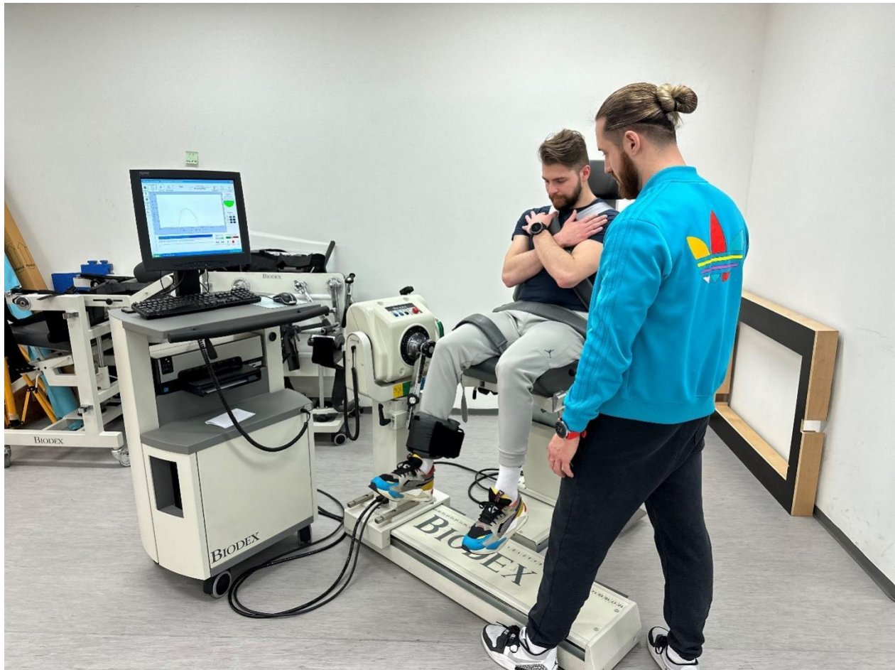
Slika 12. Mjerenje maksimalne koncentrične jakosti mišića ispružaća i pregibača koljena izokinetičkim dinamometrom
