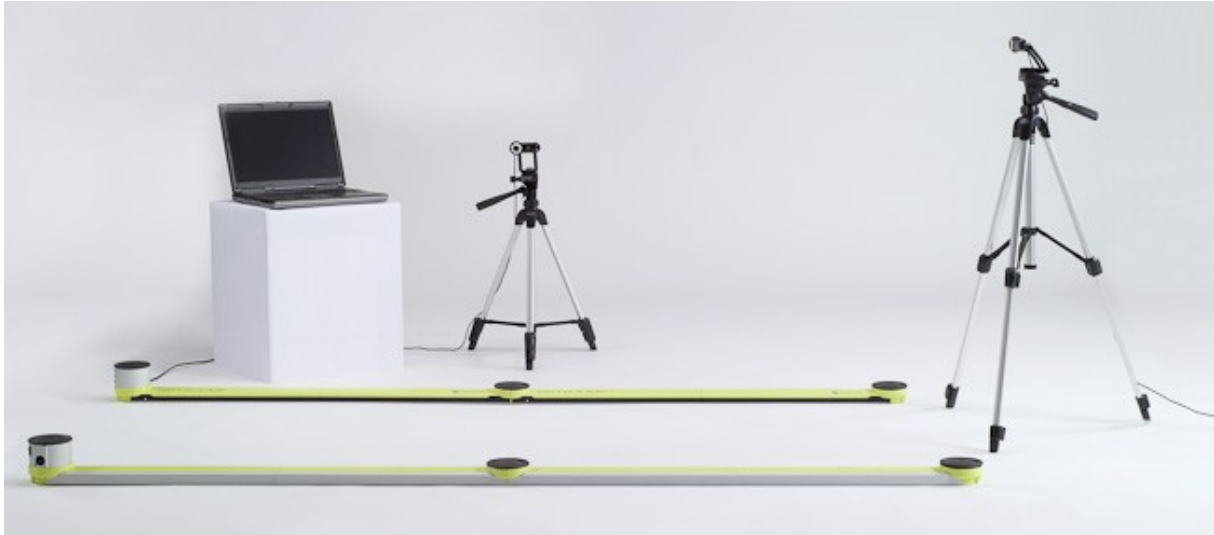
Slika 4. Optojump next sustav (Slika preuzeta sa http://www.optojump.com/What-is-Optojump.aspx )
