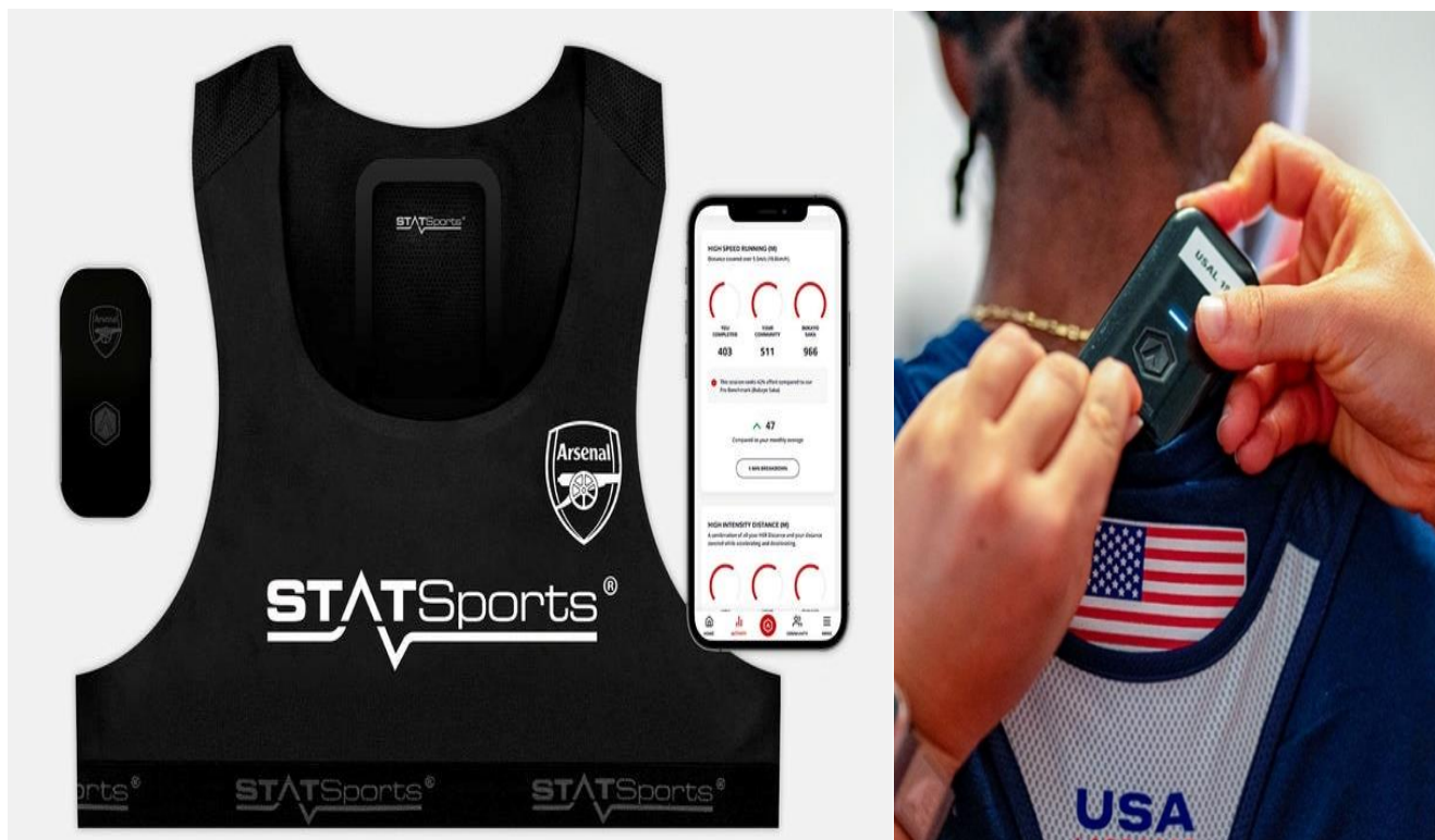
Slika 16. i 17. StatSports GPS uređaj i prsluk i postavljanje uređaja na gornji dio leđa između lopatica
