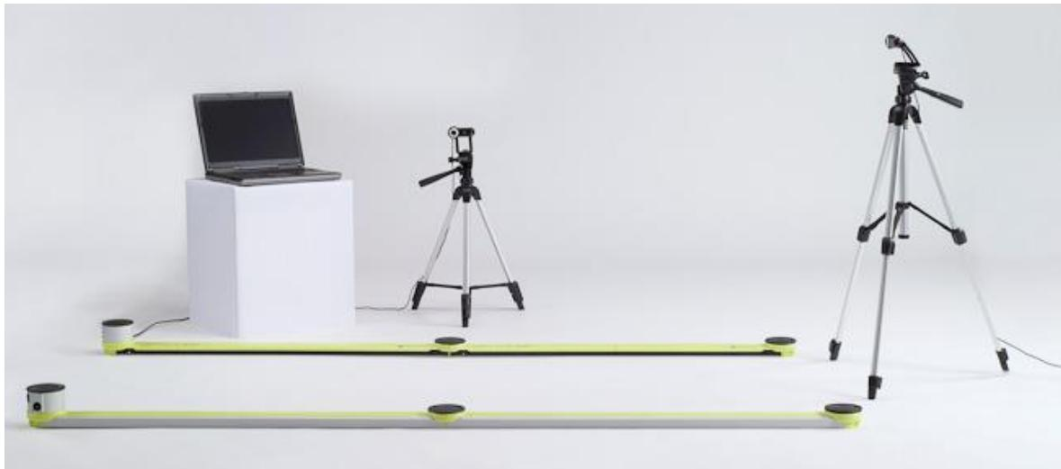
Slika 1. Prikaz Optojump mjernog sustava ([www.optjump.com](http://www.optjump.com))
