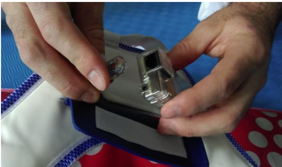
Slika 18: Spajanje bluetooth odašiljača i elektroničkog štitnika
