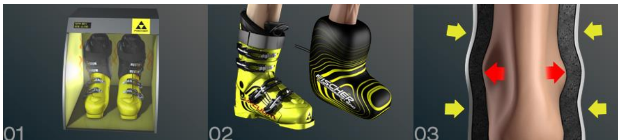
Slika 5. Fischer "Vacuum Fit" proces prilagođavanja. 01 Zagrijavanje cipela na 80°C. 02 Aplikacija kompresijskog omotača. 03 Kompresija i prilagođavanje skijaške cipele obliku stopala. (Izvor: https://morissetsports.com/en/services/fischer-vacuum-fit/ )
