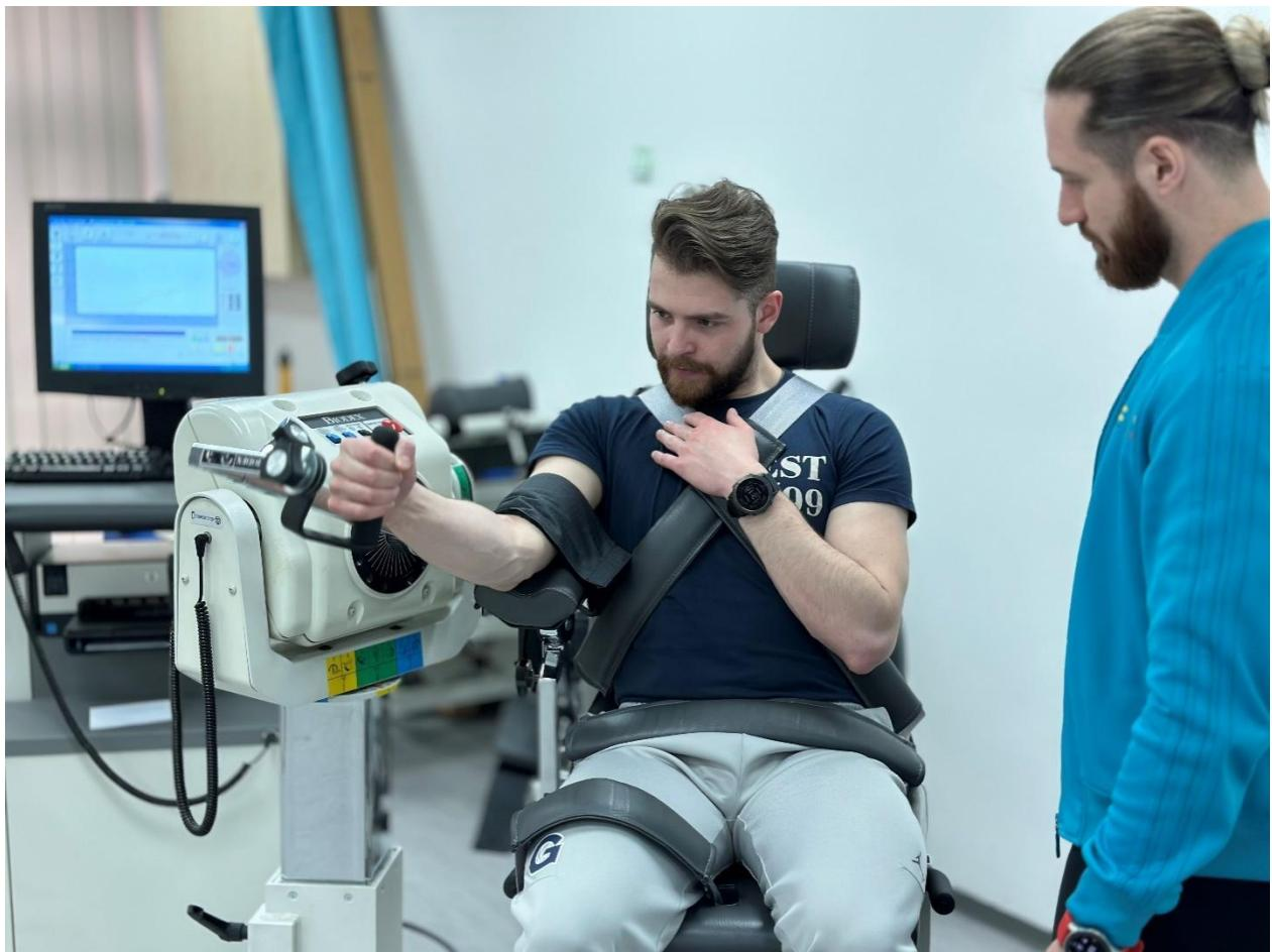
**Slika 13.** Mjerenje maksimalne koncentrične jakosti mišića ispružača i pregibača lakta izokinetičkim dinamometrom
