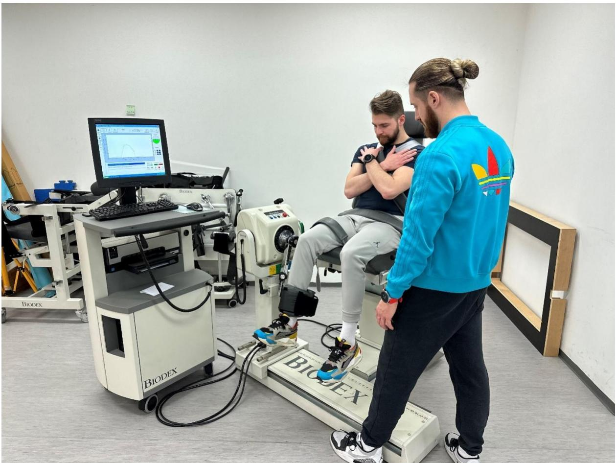
**Slika 12.** Mjerenje maksimalne koncentrične jakosti mišića ispružača i pregibača koljena izokinetičkim dinamometrom
