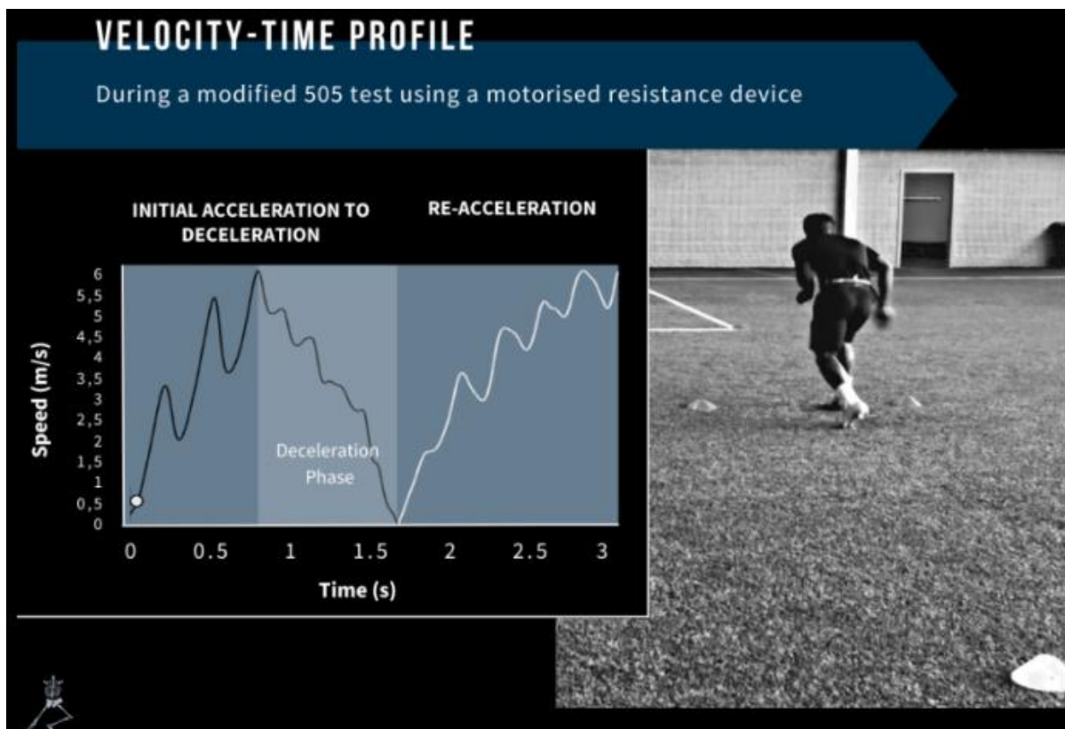
Slika 13. Primjer profila brzine u odnosu na vrijeme snimljenog tijekom modificiranog 505 testa korištenjem motoriziranog uređaja otpora. Faza usporavanja je istaknuta. Početak faze usporavanja određen je iz maksimalne brzine postignute prije skretanja, a kraj faze usporavanja definira se kada je brzina promijenila smjer. Damian Harper (2023.) „Don’t Speed Up What You Can’t Slow Down: How Are We Assessing Our Athlete’s Horizontal Deceleration Performance Capabilities?” https://sciofmultispeed.com/dont-speed-up-what-you-cant-slow-down/
