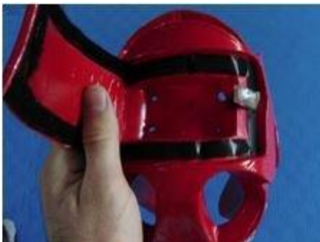
Slika 16: Džep u koji se umeće bluetooth odašiljač
