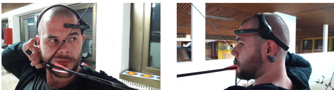
Slika 2. i Slika 3. Jednokanalni mobilni EEG sustav Mindwave Mobile sprijeda i sa strane
