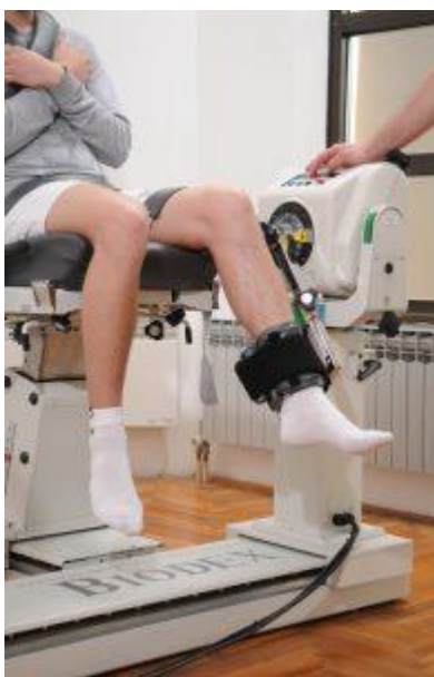
SLIKA 4. Mjerenje jakosti na izokinetičkom aparatu.
