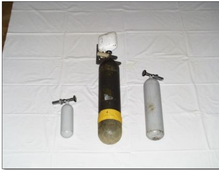
Slika 21. Spremnici za komprimirani zrak.
