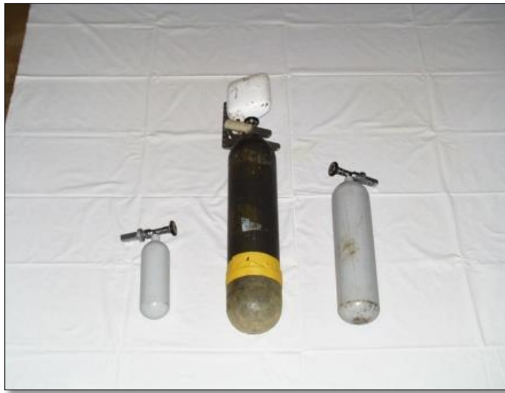
Slika 21. Spremnici za komprimirani zrak.
