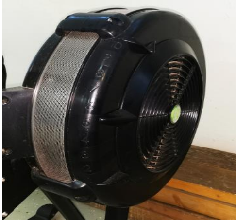
Slika 7. Concept2 zamašnjak i prigušivač (Izvor: osobna arhiva autora)
