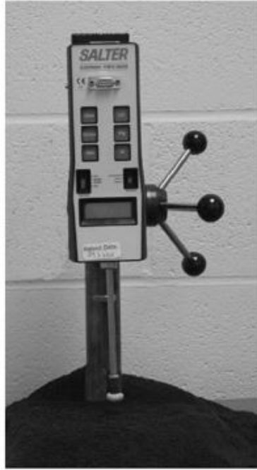
Slika 9. Uređaj za provociranje boli preuzeto iz Chesterton ( 2007)
