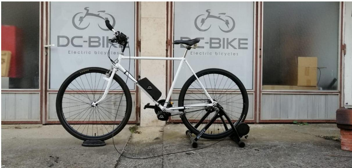
*Slika 4. Novokonstruirani električni bicikl ergometar*
