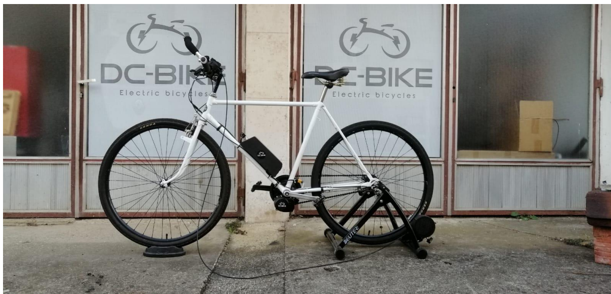
Slika 4. Novokonstruirani električni bicikl ergometar
