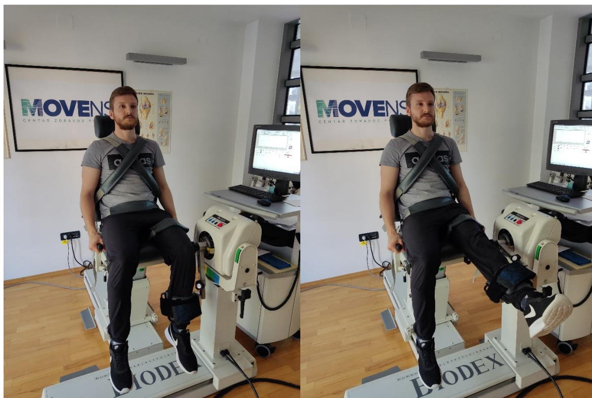
Slike 1 a) i 1 b): Početna i završna pozicija jednog ponavljanja tijekom testiranja jakosti mišića natkoljenice na izokinetičkom dinamometru marke Biodex System 4 Pro.
