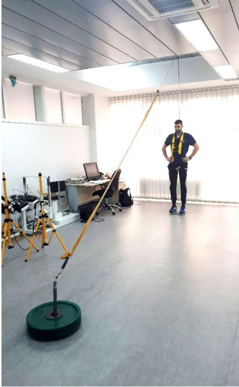
Slika 17. Prikaz sustava za rasterećenje
