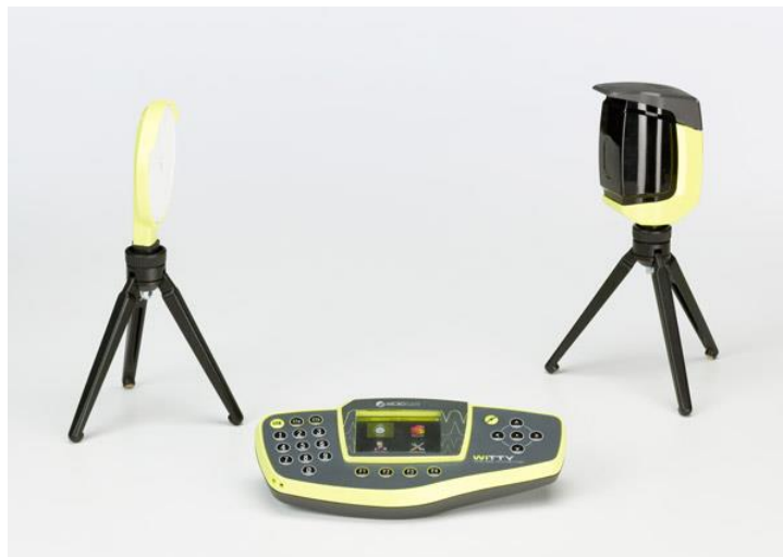
Slika 3. Witty sustav za mjerenje vremena. (preuzeto sa: https://training.microgate.it/en/products/witty/wittygate )
