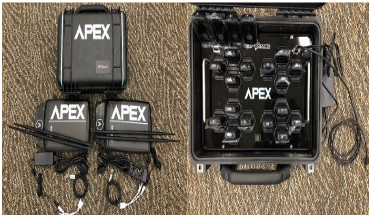
Slika 18. Bazna stanica u koju se postavljaju GPS uređaji kako bi se prikupili podaci nakon utakmice
