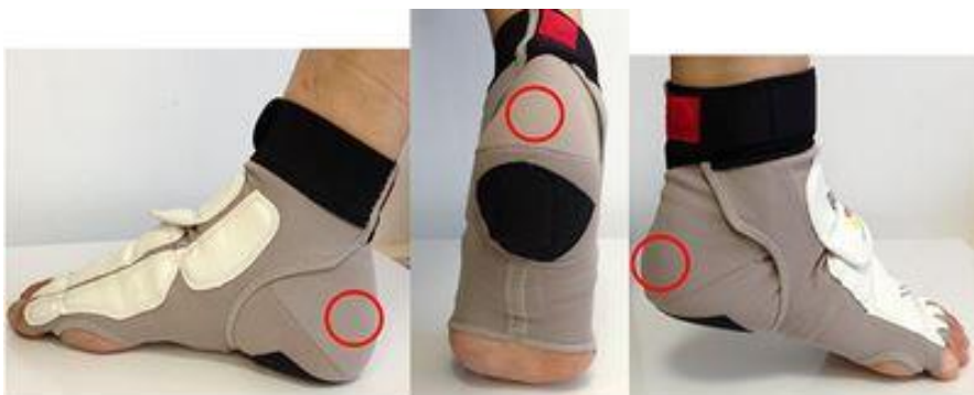
Slika 21: Štitnik za stopala sa senzorom na peti
