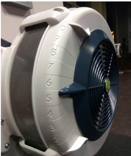
Slika 14. Zamašnjak, kotač sa lopaticama kojise nalazi u zatvorenom bubnju, podešavanje opterećenja smješteno na desnoj strani
