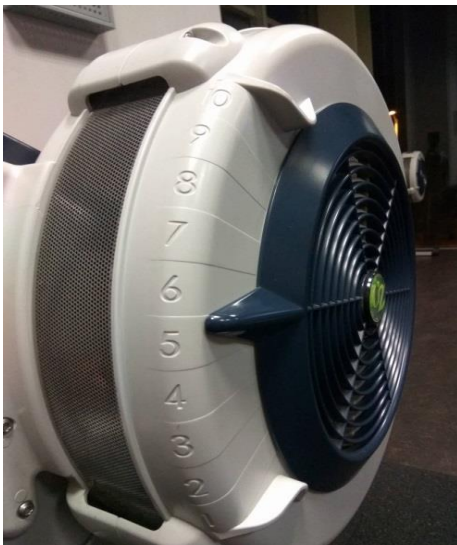
Slika 14. Zamašnjak, kotač sa lopaticama kojise nalazi u zatvorenom bubnju, podešavanje opterećenja smješteno na desnoj strani
