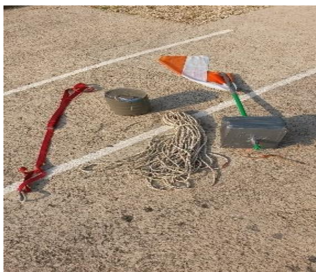
Fotografija 7. Plutača sa sidrenim konopom, utegom i gurtinom
