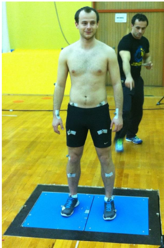
Slika 11. Ispitanik stoji na platformama za mjerenje sile reakcije podloge
