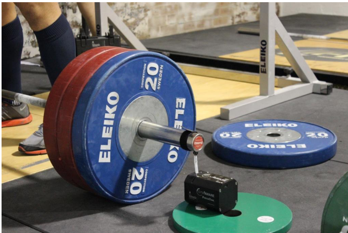
Slika 3. Gymaware uređaj za mjerenje kinetičkih parametara (Gymaware, Kinetic Performance Technologies, Canberra, Australia).
