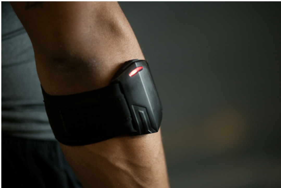
Slika 4. PUSH traka za mjerenje kinetičkih parametara (PUSH, Inc., Toronto, Canada)
