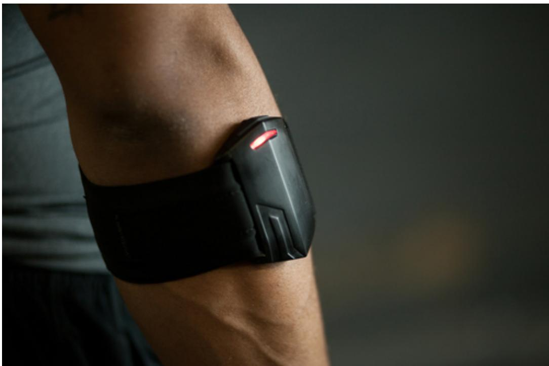
*Slika 4. PUSH traka za mjerjenje kinetičkih parametara (PUSH, Inc., Toronto, Canada)*
