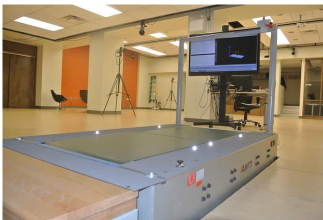
Slika13 - Traka za trčanje sa pločom za mjerenje sile reakcije podloge ( hmrc.engineering.queensu.ca )
