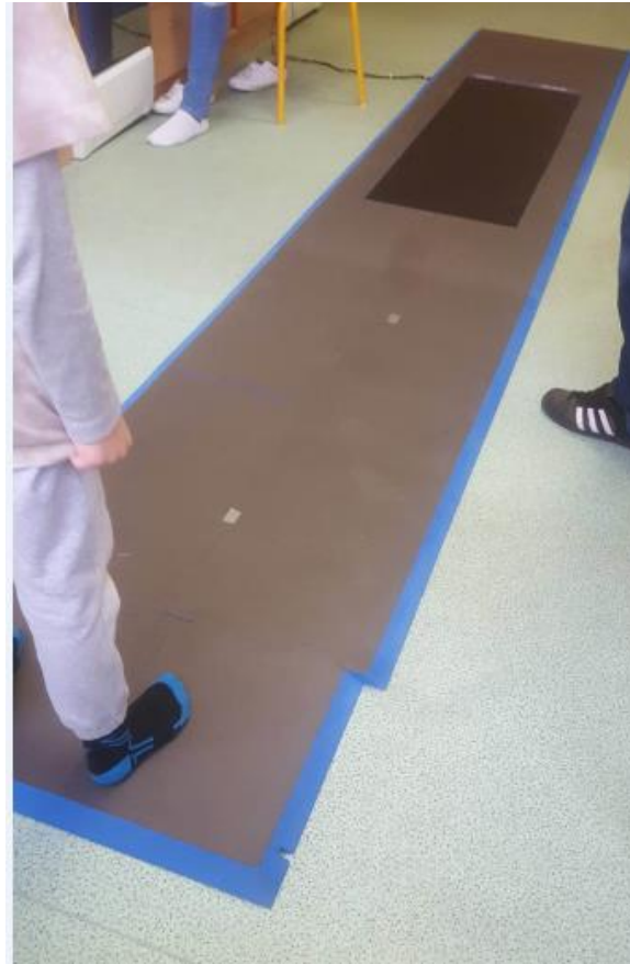
Slika 1. Prikaz mjerne staze i pedobarografske platforme za analizu hoda
