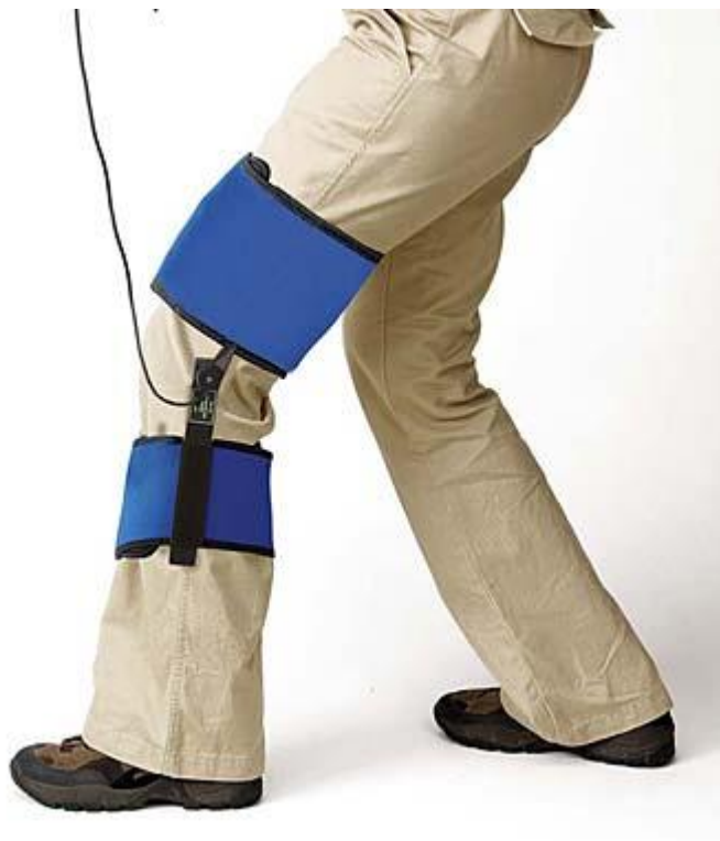
Slika 17. Mjerenje kuta u koljenu pomoću Pasco Xplorer goniometra
