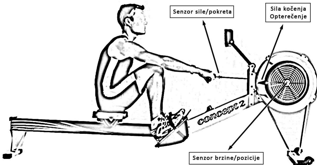
**Slika 2.** Veslački ergometar tipa „Concept 2“ opremljen senzorima za mjerjenje sile i brzine.
