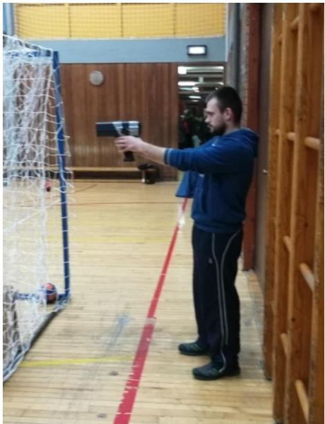
**Slika 7:** Mjerjenje brzine kretanja lopte radar pištoljem (Stalker ATS)
