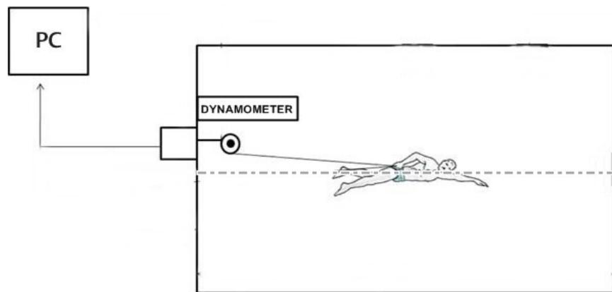
Slika 2. Prikaz mjerjenja dinamometrije plivača
