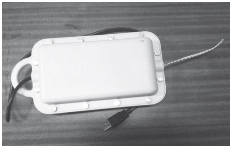
*Slika 1. Dinamometrijska sonda*
